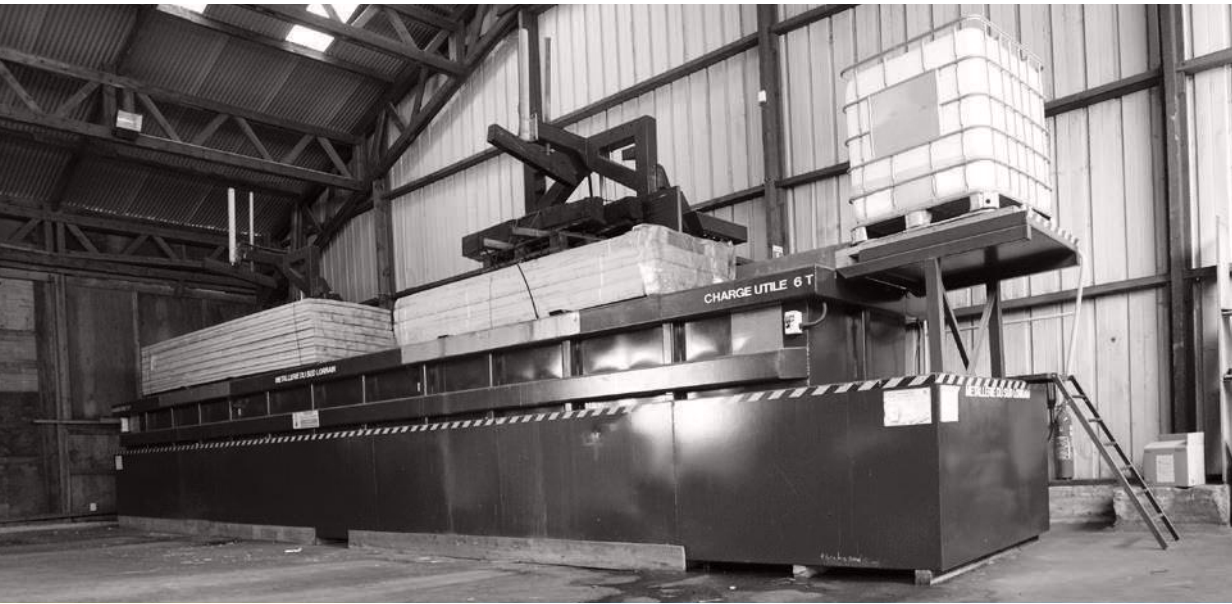
Bac de préservation Classe 2 - Site de Bouguenais (44)
