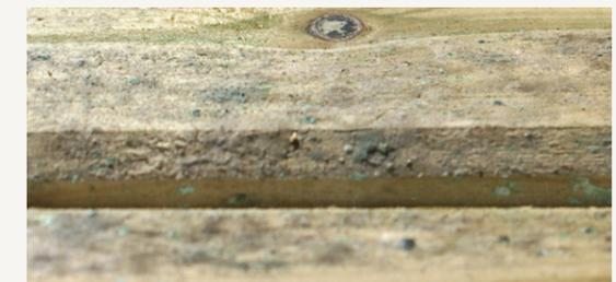
Les bois sont sujets aux moisissures de discoloration, provoquées par des champignons microscopiques. Cette discoloration superficielle, renforcée par la chaleur, l'humidité et le manque d'aération, se caractérise par des tâches allant du bleu clair au bleu noir. Un léger brossage permet de les éliminer.
