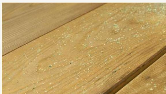
Les bois préservés en autoclave présentent fréquemment de petites taches vertes ou blanchâtres en surface. Elles disparaissent généralement de façon spontanée après la pose. Au besoin, vous pouvez les brosser légèrement.
